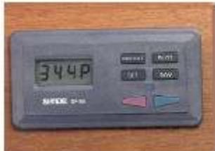
É um aparelho para controle automático do rumo. Este aparelho permite manter o navio no rumo sem necessidade de timoneiro. Além de dispensar o homem do governo do navio, o piloto automático apresenta a vantagem no consumo de combustível e menor desgaste de máquina do leme.
