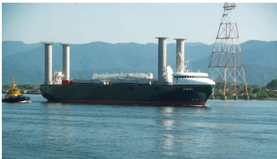
Navio E-SHIP 1, com seus quatro rotores de 27 metros de altura.
